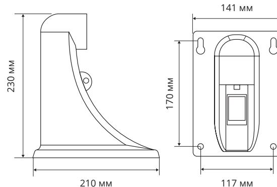
Адаптер для монтажа на трубу APIX TUBEPLATE / S2
