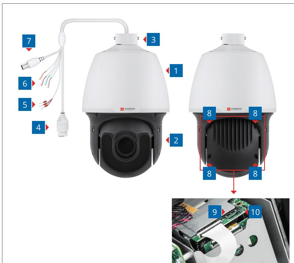
**1** Корпус камеры **2** Поворотное устройство
