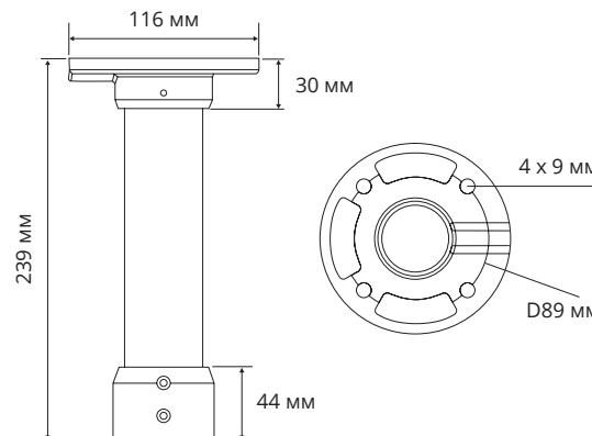
Адаптер для монтажа на угол APIX CORNERPLATE / S2
