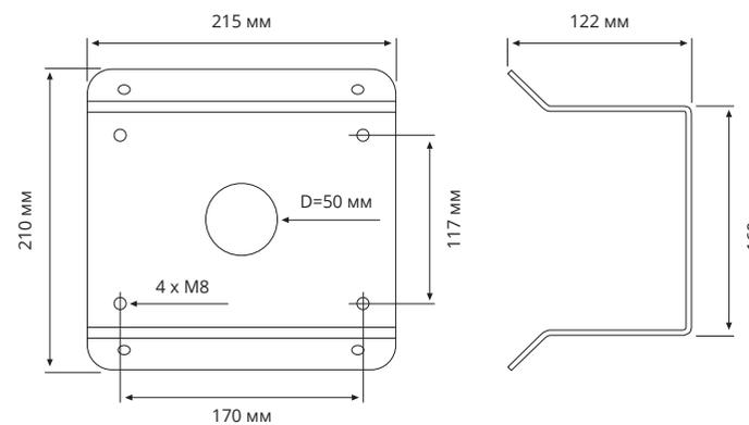
\* Видеокамера не может быть закреплена напрямую на адаптере APIX CornerPlate / S2, обязательно нужен кронштейн APIX WallMount / S2
