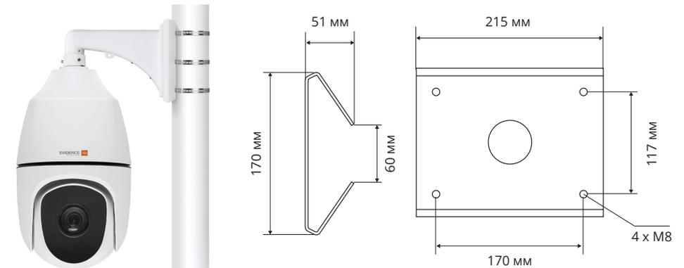
Потолочный кронштейн **APIX CEILINGTUBE / S2**
