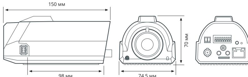
При установке видеокамеры в уличный гермокожух необходимо также учитывать размеры выбранного объектива и дополнительные 10 мм DC-коннектора, который подключается к разъему на левой стороне камеры
